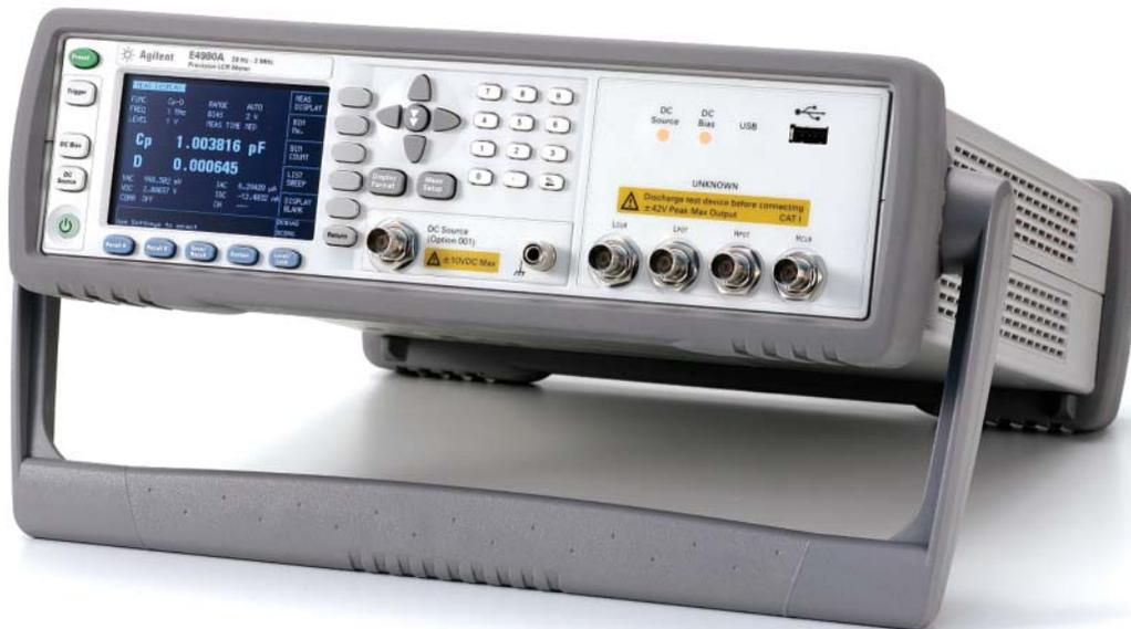
Figure 1. Agilent E4980A Precision LCR Meter
