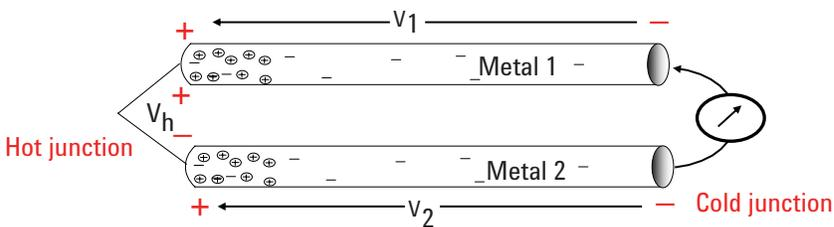
$$V_0 = V_2 + V_H - V_1$$
