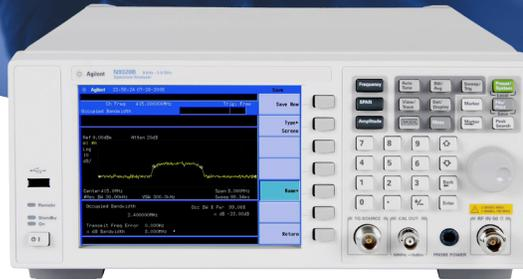
*Agilent N9320B RF spectrum analyzer*
