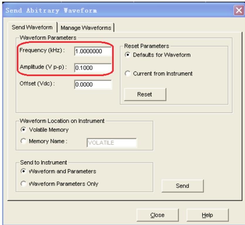
Figure 9. Waveform parameter setup
