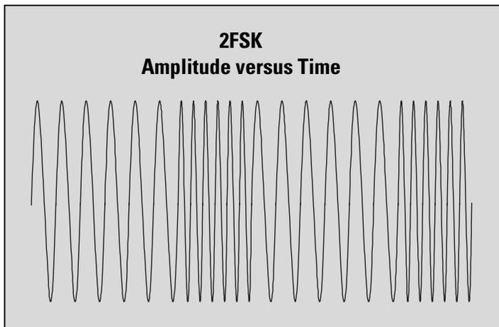
**Figure 3. 2FSK modulation**
