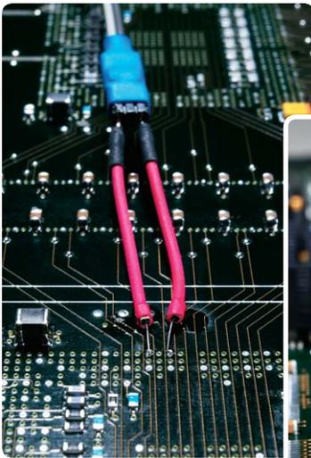
...probe the back side of a BGA
