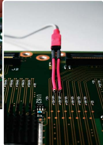
...probe surface mount resistors
