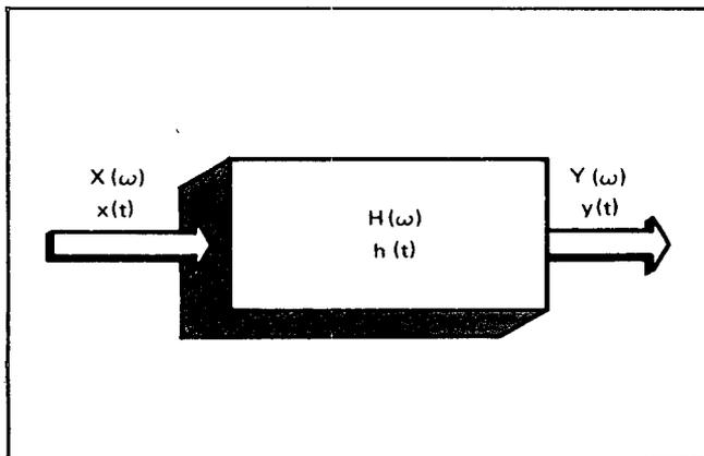
FIG 1. SINGLE INPUT/SINGLE OUTPUT SYSTEM
