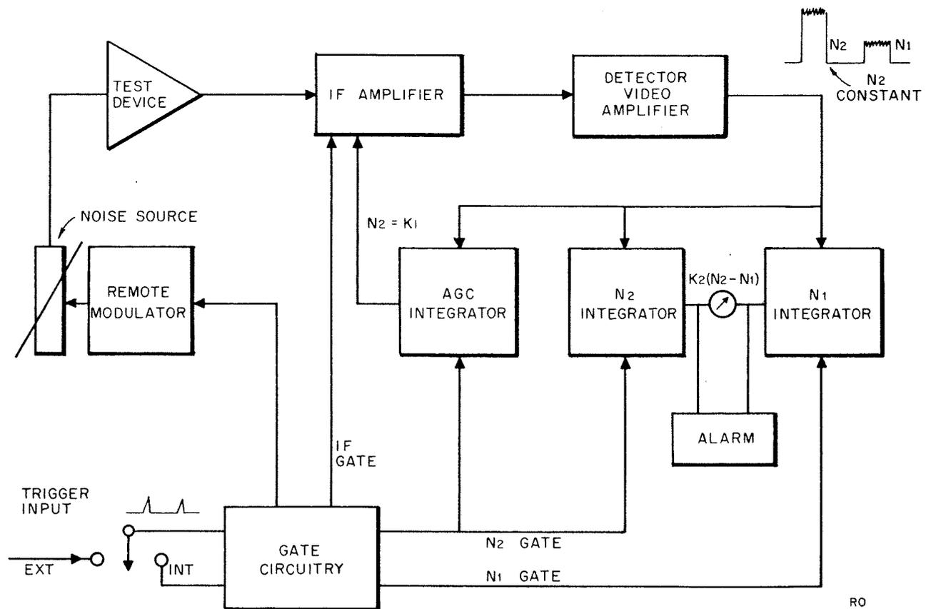
Figure 4.  $\text{hp}$  344A Noise Figure Meter Block Diagram
