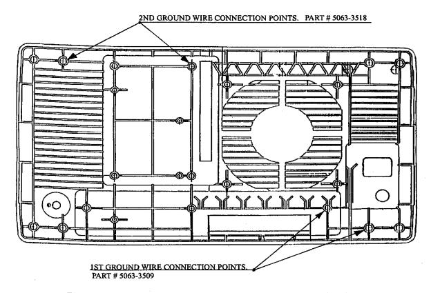
PT BACK BEZEL GROUNDING WIRES UPGRADE
