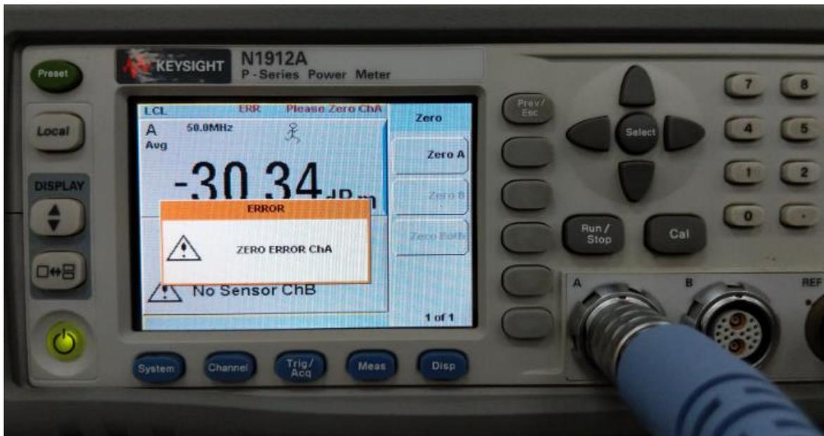
Figure 1: ZERO ERROR'/'CAL ERROR' Message
